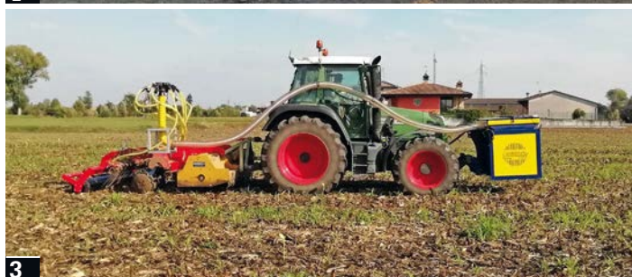
Il prototipo di seminatrice abbinata a: distribuzione dei liquami (1), mietitrebbiatura (2), trinciatura del mais (3) e rincalzatura (4)
