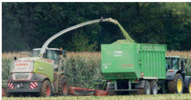
Enchimento completo da caixa de reboque utilizando a análise de imagem.
