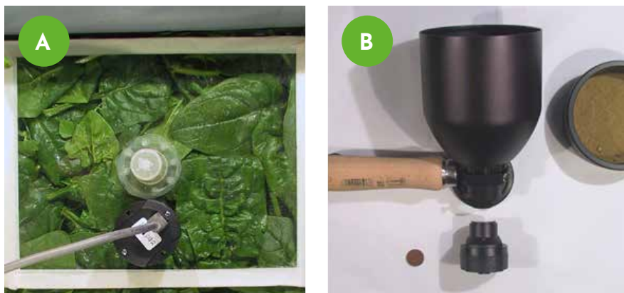
Figura 6.1 Strumenti utilizzati per l'analisi spettroscopica. Strumento portatile (MicroNIR, Viavi) usato per acquisire gli spettri nella regione NIR A) delle piante verdi e B) delle piante essiccate e macinate.
