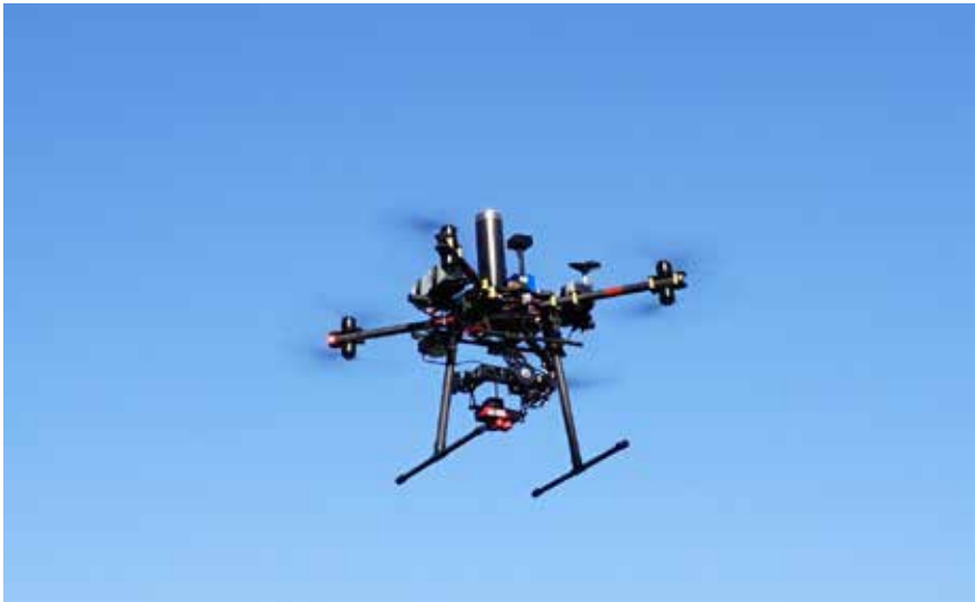
Figura 5.1 Ottacottero coassiale usato nella sperimentazione che monta la camera MicaSense RE.
