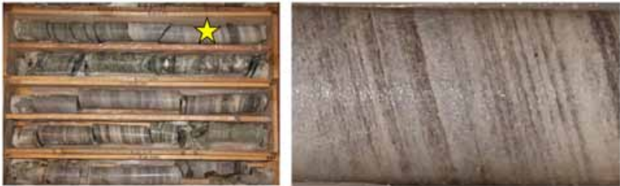
Fig.3.42: Carotaggio del sondaggio BBT Vi-B12/1,1 da cui è stato prelevato il campione Vi-B12-15 (stella gialla). A destra è possibile osservare il frammento di carota prelevato (un calcescisto dell'unità del Glockner caratterizzata dalla fitta alternanza di livelli ricchi in carbonato e livelli ricchi in fillosilicati e granato).
