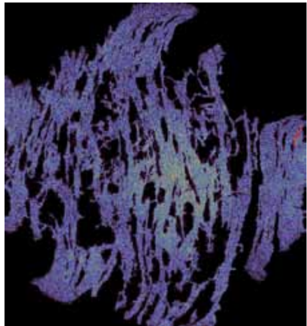
Fig.5.29: Mappa ai raggi X relativa alla variazione di Ca all'interno del granato del campione 7AD-52.
