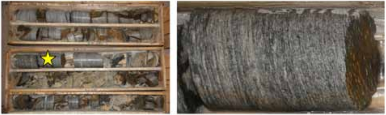
Fig.3.38: Carotaggio del sondaggio BBT Vi-B12/1,1 da cui è stato prelevato il campione Vi-B12-34 (stella gialla). A destra è possibile osservare il frammento di carota prelevato (un calcescisto dell'unità del Glockner).
