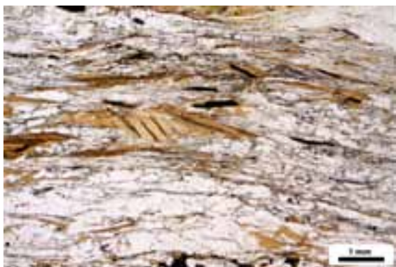
Fig.3.100: Foliiazione principale S2 definita da mica chiara e biotite e cristalli relitti di biotite che definiscono una foliazione S1. Campione 7AD-37. Immagine a N//.
