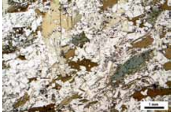
Fig.3.89: Cristalli di biotite, anfibolo (verde), quarzo e feldspati (incolori). Campione 7SZ-1080. Immagine a NX.
