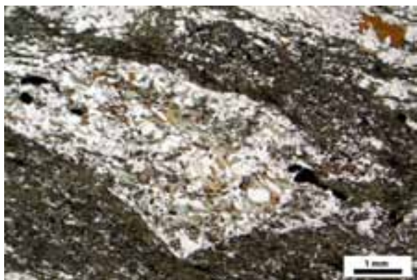
Fig.3.22: Pseudomorfo di lawsonite costituito da un aggregato a grana fine di da quarzo, feldspato, clorite, biotite e carbonato. Campione 7AD-16. Immagine a N//.
