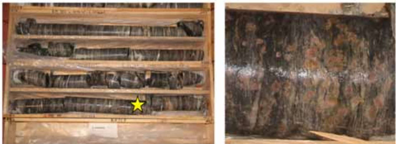
Fig.3.43: Carotaggio del sondaggio BBT Vi-B12/1,1 da cui è stato prelevato il campione Vi-B12-27 (stella gialla). A destra è possibile osservare il frammento di carota prelevato (un micascisto a granato delle coperture Mesozoiche).
