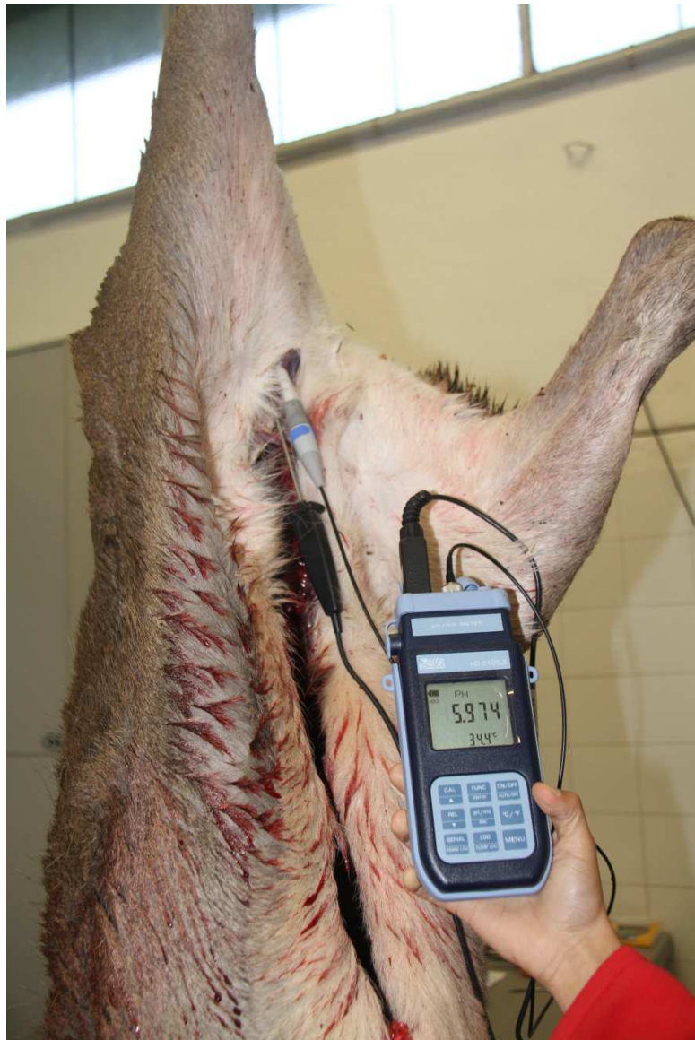
Figura 1: Misurazione del pH su carcassa di cervo. Oltre allo strumento si nota sonda di misurazione del pH e sonda termometrica.
