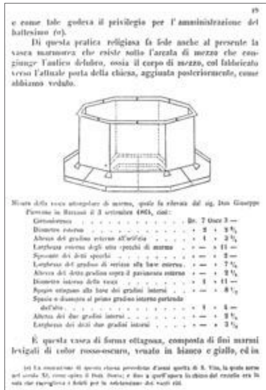
65. Rilievo assometrico, con misure in braccia e onces, del fonte battesimale di San Salvatore a Barzanò, secondo Celestino Mantovani (1864).
