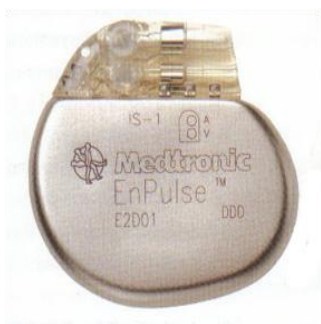
Figura 1: Un esempio di generatore di impulsi o PM.
