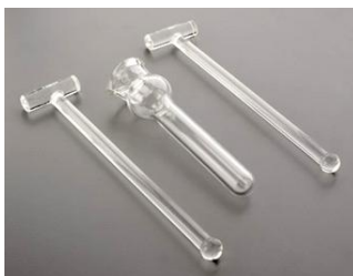
Figura 15: Immagine dei pestelli A e B e del mortaio di vetro che compongono l'omogeneizzatore di Potter.
