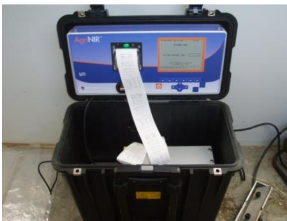
Fig. 18 – Sensore NIR portatile utilizzato per la predizione della composizione chimica della razione.
