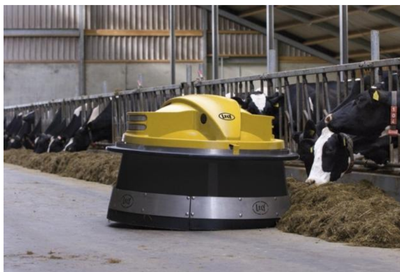
Fig. 11 – Macchina automatica a navigazione sensorizzata per il riavvicinamento ad elevata frequenza di razioni unifeed.
