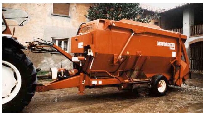
Fig. 3 – Il carro desila-trincia-miscelatore Sgariboldi Monofeeder 9 DF da 9 m 3 utilizzato.
