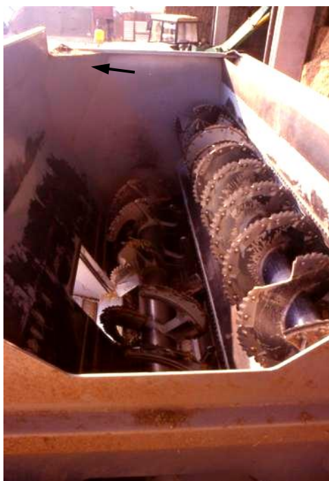
Foto 2 - Il sistema di trinciamiscelazione a due coclee sovrapposte e disassate con spirali contrapposte. La freccia evidenzia uno dei due deflettori triangolari destinati ad impedire la formazione di ristagni di prodotto in corrispondenza degli spigoli liberi del cassone e a favorirne la ricaduta verso le coclee.
