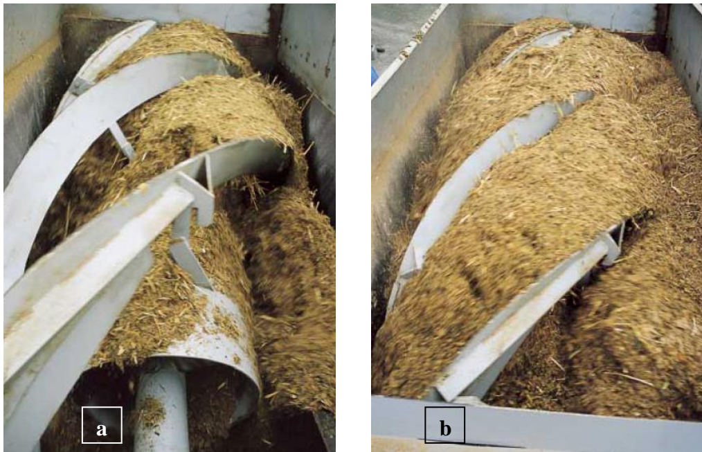
Fig. 9 - Prototipo di un sistema di miscelazione caratterizzato da un aspo elicoidale, rotante in senso antiorario, che spinge il prodotto verso la parte anteriore del cassone e da una coclea tubolare coassiale che riporta posteriormente gli ingredienti completando il flusso di miscelazione. (a) Si noti, in uscita dalla coclea tubolare, il flusso di ritorno che consente di completare il ciclo di miscelazione. (b) La macchina a pieno carico durante la realizzazione di una razione per vitelloni da carne con silomais trinciato lungo a 24 mm.
