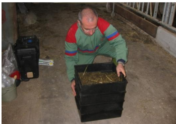
Fig. 19 – Separatore di particelle a tre setacci della Penn State University.
