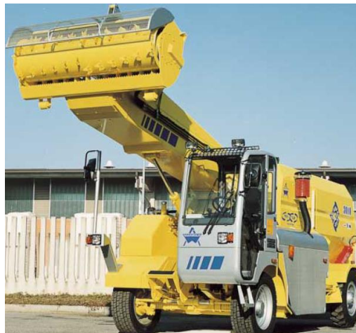
Fig. 3 - I carri semoventi sono dotati di desilatrici a fresa polivalenti per caricare tutti gli ingredienti (Foto: Sgariboldi).
