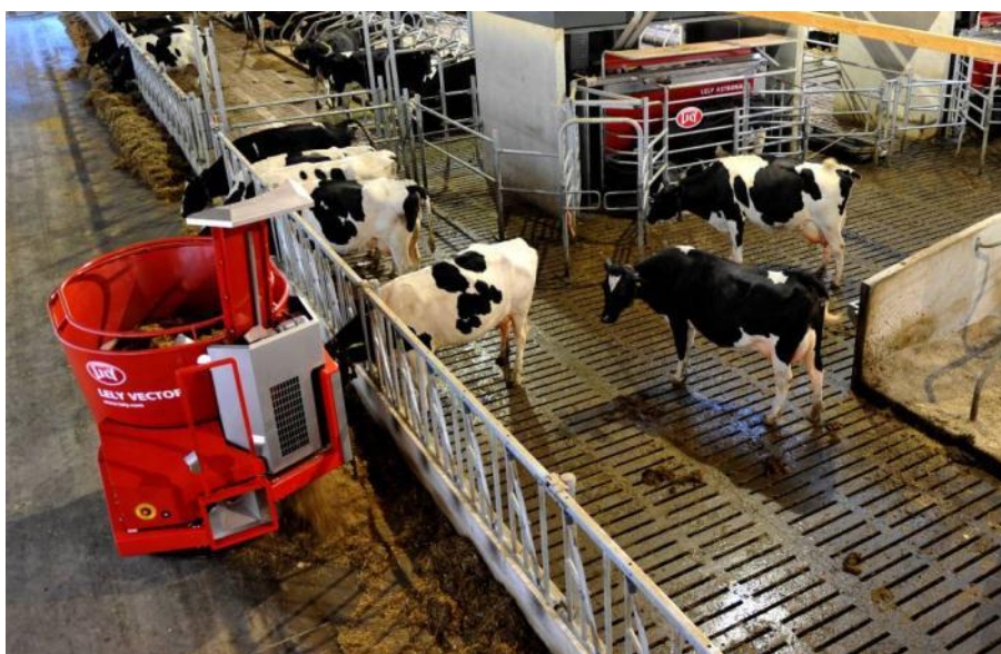
Fig. 13 – Il più recente sistema per la preparazione e distribuzione automatica di unifeed si basa su una modalità di navigazione sensorizzata.
