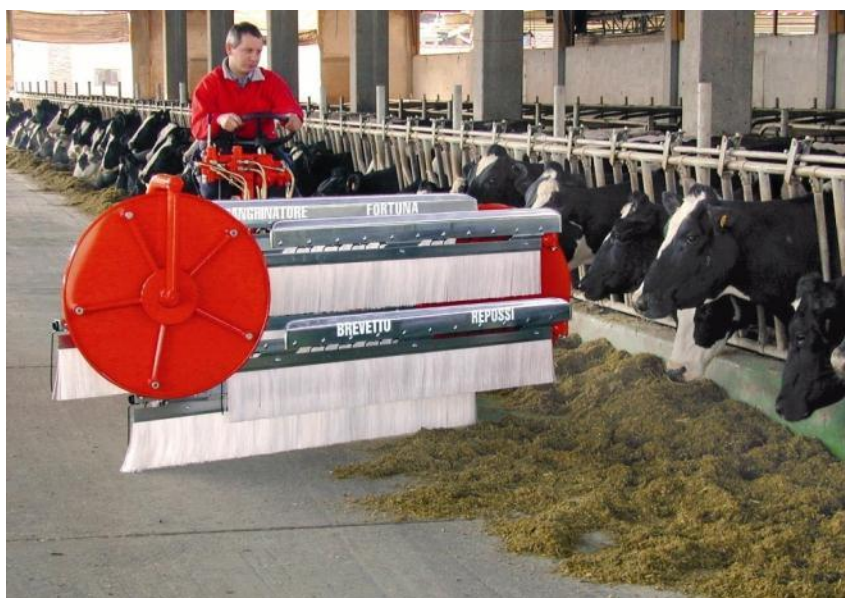
Fig. 9 – Esempio di macchina semovente per il riavvicinamento della razione in mangiatoia
