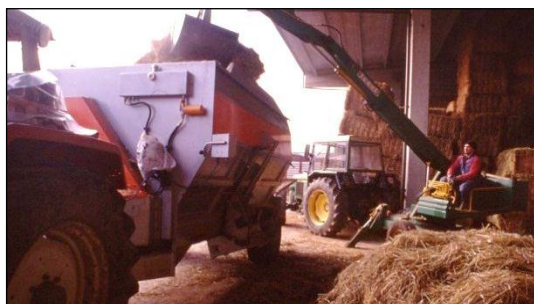
Foto 3 – Carico graduale di fieno di loiessa con caricatore a benna. L'immissione del fieno dal lato sinistro sembra più agevole data l'assenza della coclea superiore.
