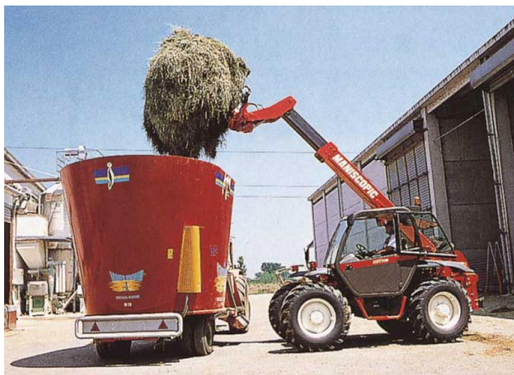
Fig. 1 - Per le operazioni di carico dei modelli trainati senza desilatore è necessario prevedere attrezzature per l'immissione dei singoli componenti. Particolare interesse stanno suscitando anche in Italia, i caricatori telescopici (Foto: Manitou).
