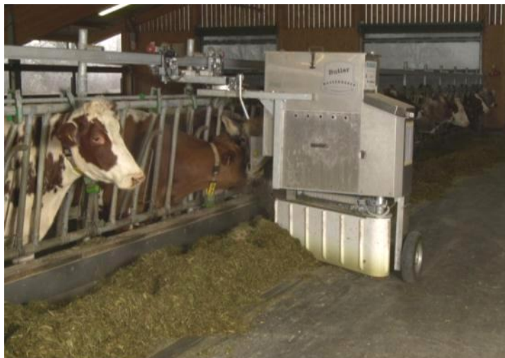
Fig. 10 – Macchina automatica vincolata alla rastrelliera per il riavvicinamento della razione in mangiatoia e la distribuzione di piccole dosi di mangime concentrato.
