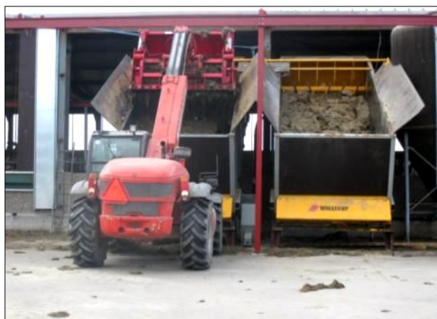
Fig. 52 – Le operazioni di carico dei sili temporanei per i foraggi che alimentano automaticamente il vagone miscelatore, possono essere eseguite ad orari flessibili e, in determinati periodi dell'anno, ogni 2-3 giorni, in funzione delle dimensioni della mandria e del volume dei sili.
