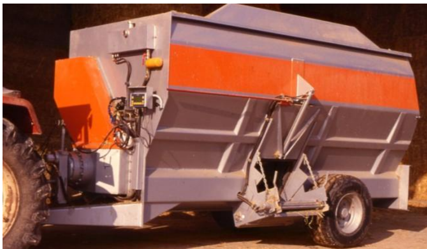
Foto 1 - Il prototipo di carro trinciamiscelatore nel corso delle prove. Si noti il carter anteriore che protegge la trasmissione a catena della coclea superiore, posta sul lato destro del cassone.
