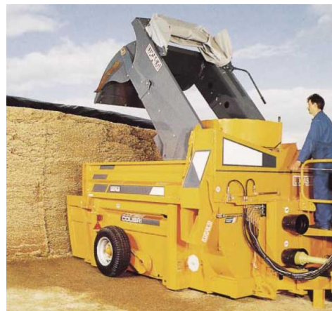
Fig. 5 - Desilatrice a blocchi. Il vantaggio di tale dispositivo consiste nel preservare la lunghezza di trinciatura del prodotto conservato (Foto: Lucas).
