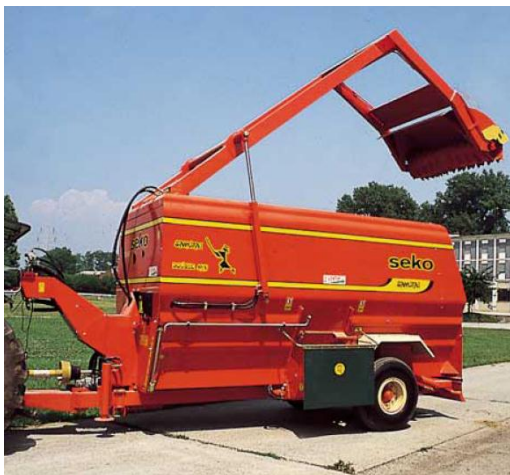
Fig. 2 - Le desilatrici a fresa sono generalmente preferite per il carico degli insilati.
