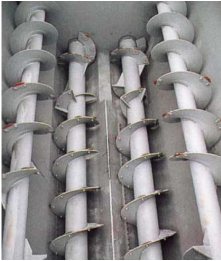
Fig. 7 - Dispositivo di trinciamiscelazione a coclee orizzontali. I sistemi a 3-4 coclee orizzontali montano spirali continue sullo stesso asse affidando alle coclee inferiori l'avanzamento del prodotto e a quelle superiori il ritorno posteriore per completare i flussi di miscelazione (Foto: Mutti).
