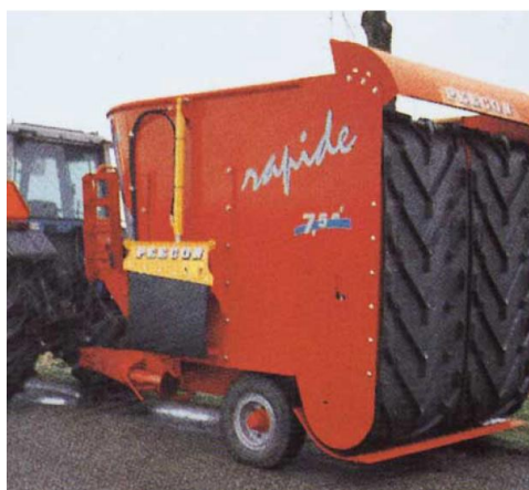
Fig. 4 - Desilatrice a nastro applicata ad un carro miscelatore a coclea verticale; il dispositivo può essere dotato di risalti in gomma o di denti metallici (Foto: Peecon).
