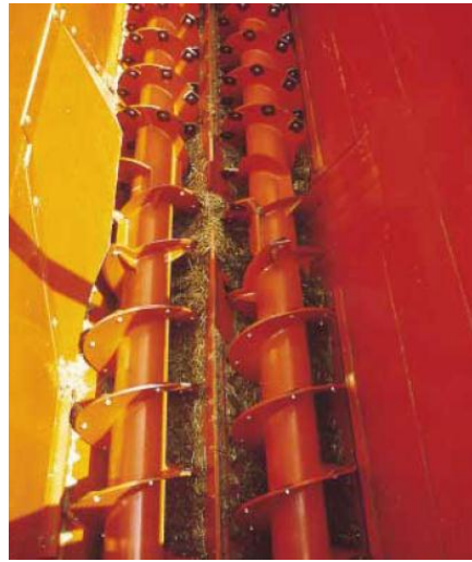
Fig. 8 - Dispositivo di trinciamiscelazione a coclee orizzontali. I sistemi a 1-2 coclee orizzontali montano spirali contrapposte sullo stesso asse realizzando flussi convergenti di prodotto; il completamento dei flussi di ritorno è affidato alla spinta operata dal prodotto stesso.
