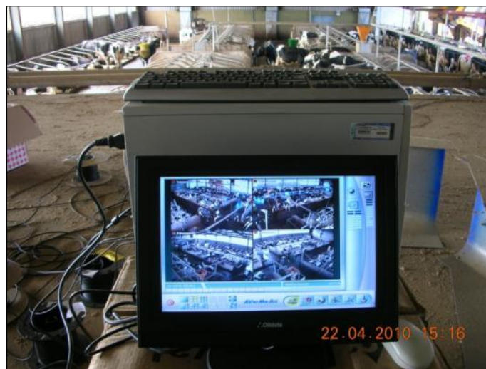
Fig. 20 – La postazione di registrazione su personal computer è stata posizionata sul tetto dei box robotizzati di mungitura. Si notano a monitor i quattro quadranti della stalla su cui sono state puntate le relative videocamere.
