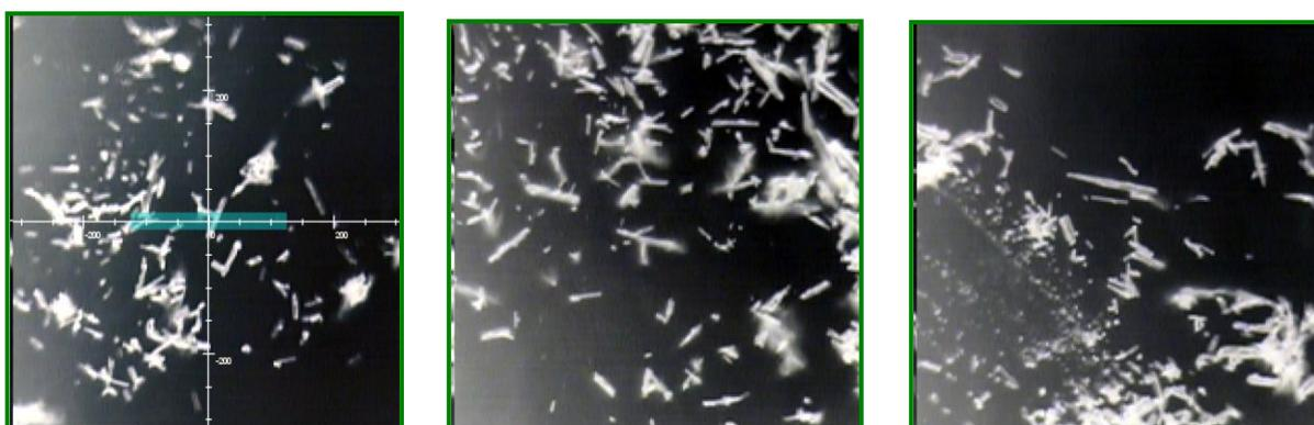
**Figura 18** Fotografie campo visibile 600X600 µm (ingrandimento16X) di cristalli di Pimecrolimus forma idrata
