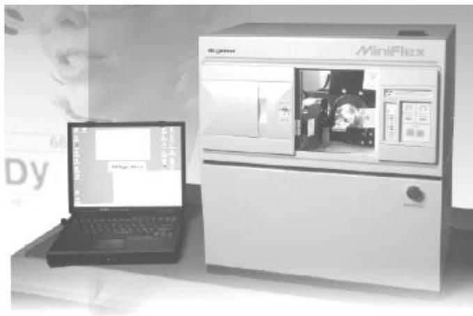
**Figura 9** Diffratometro Rigaku MiniFlex interfacciato a PC
