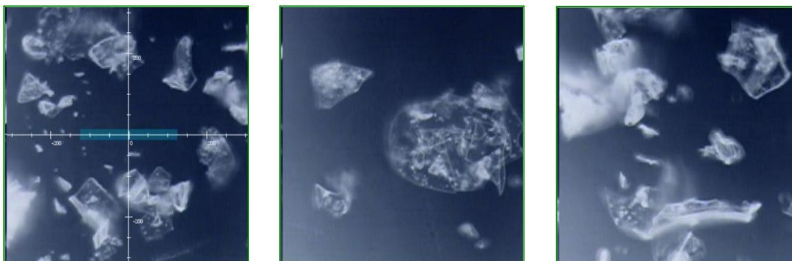
**Figura 22** Fotografie campo visibile 600X600  $\mu\text{m}$  (ingrandimento 16X) di cristalli di Pimecrolimus forma amorfa
