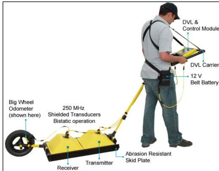
Fig. 4.14: Immagine della strumentazione utilizzata per la ricerca con georadar
