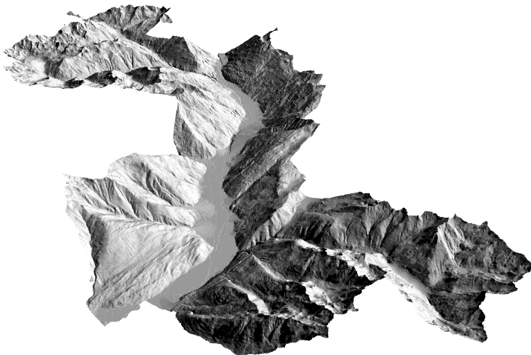
Fig. 3.2 – Modello digitale del terreno (DEM) ombreggiato che evidenzia il tratto di fondovalle dove scorre il fiume Adda e la disposizione delle principali valli laterali.
