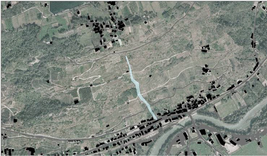
Fig. 9.4 - Abitato di Tresenda (Teglio) – In azzurro è stato sovrapposto alle ortofoto il debris flow del 26 novembre 2002. In nero sono rappresentati gli elementi vulnerabili estratti dal DB2000.
