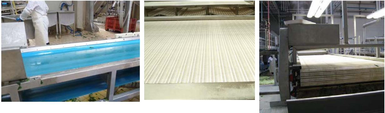
Fig. 9.2. I tappeti usati per la preparazione del Cubello. A destra il tappeto flat top per lo spinacio fresco e lavato, al centro e a sinistra il modulare aperto per lo spinacio cotto
