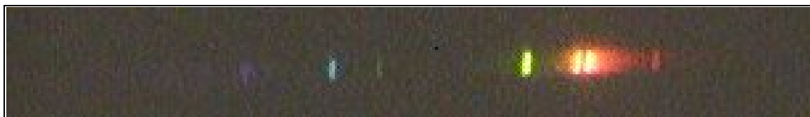
Fig.1.6. Spettro di emissione di una lampada al sodio, sono ben visibili le linee del doppietto di lunghezze d'onda 589, 589.6 nm. Le linee del doppietto del sodio assumeranno un ruolo di particolare importanza nei primi anni dello sviluppo della meccanica quantistica; ipotizzando che erano dovute all'interazione spin-orbita per gli elettroni dell'atomo di sodio, si pose così fine alla ricerca della loro origine misteriosa
