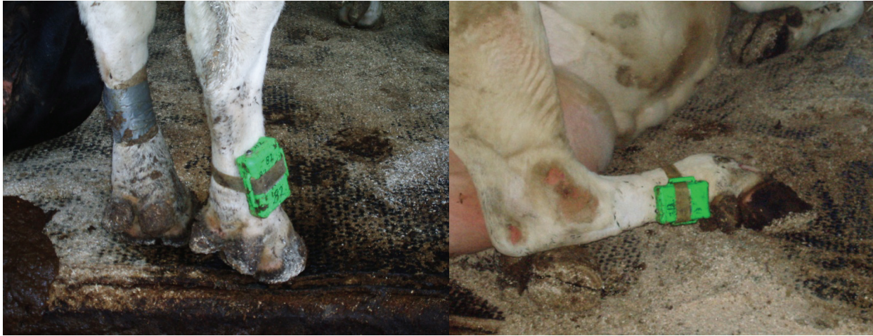
Figura 1.12. Dispositivo per il rilievo del tempo trascorso dalla bovina sdraiata e in piedi, montato sull'arto posteriore destro.
