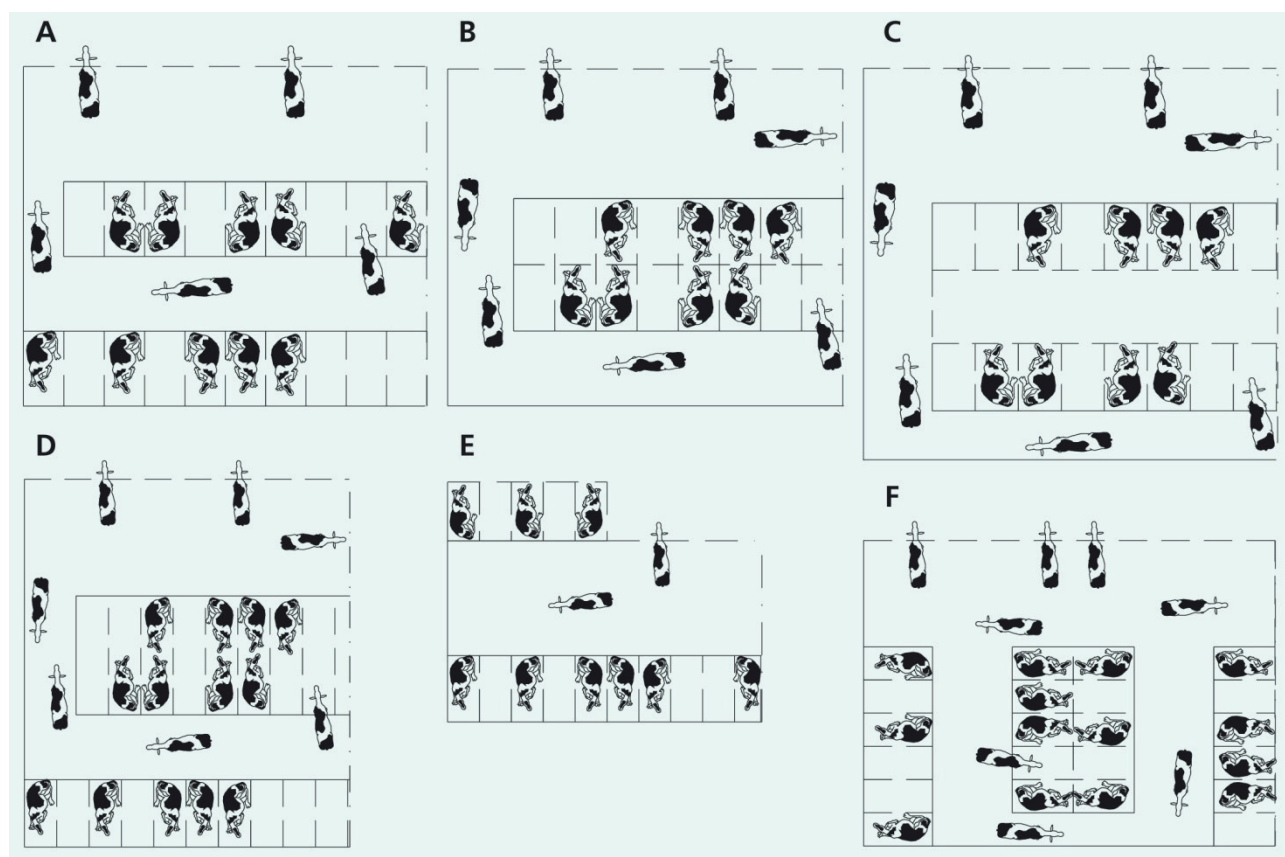
Figura 1.1. Principali tipologie di stalle libere a cuccette per mandrie di medie dimensioni: A) due file groppa a groppa; B) due file testa a testa; C) due file testa a testa con corsia della paglia; D) tre file; E) una fila con cuccette di recupero; F) più file disposte perpendicolarmente all'asse longitudinale della stalla.
