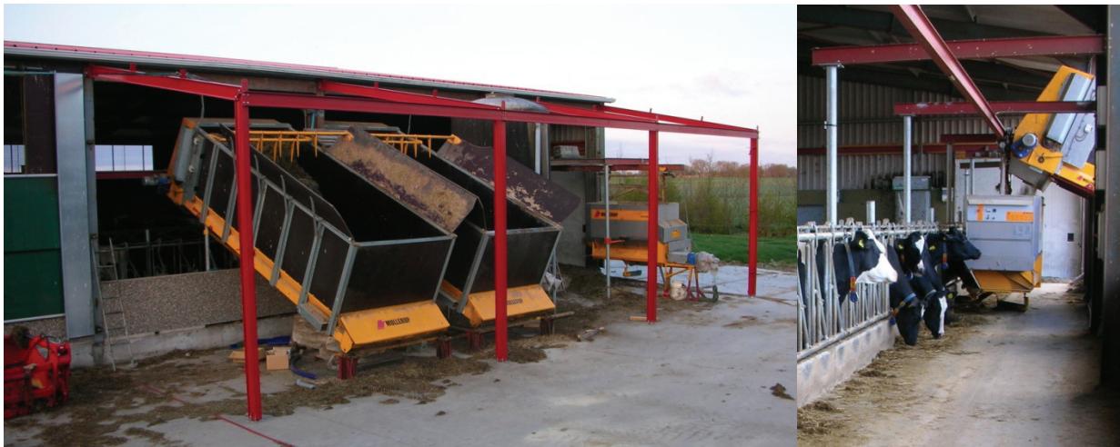
Figure 1.6. Sistema automatico di distribuzione e preparazione dell'unifeed per gruppi mobile con vagone distributore e miscelatore su rotaia.
