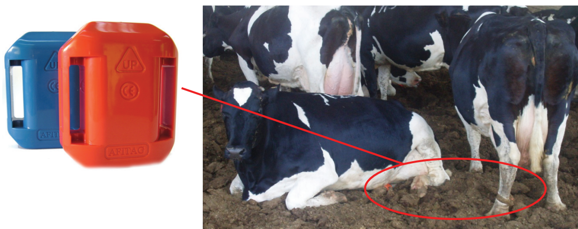
Figura 3.5. PedometerPlus Tag e posizione del dispositivo sull'arto posteriore della bovina.
