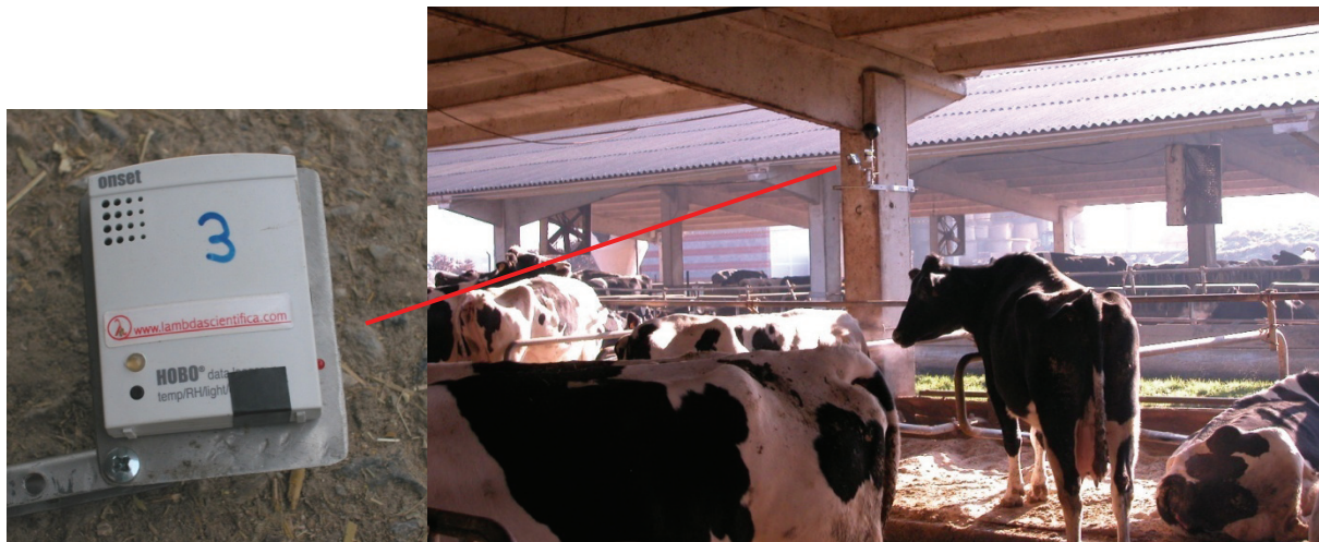
Figura 3.7. HOBO U12, Temp/RH/Light/External Data Logger per il monitoraggio delle condizioni ambientali (temperatura e umidità relativa) con relativo supporto per l'installazione all'interno della struttura.
