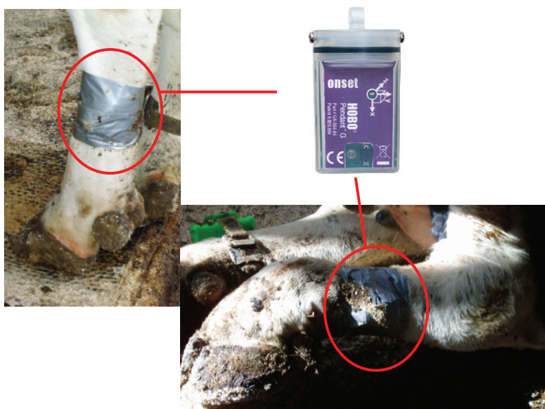
Figura 3.3. HOB0 Pendant G Acceleration Data Logger e installazione del dispositivo sull'arto posteriore della bovina.
