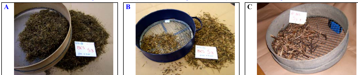
Figura 7 - Crivelli utilizzati per la suddivisione in classi dimensionali dei campioni di trinciato. (A) Crivello con maglia di 3 mm. (B) Crivello con maglia di 5 mm. (C) Crivello con maglia di 14 mm.
