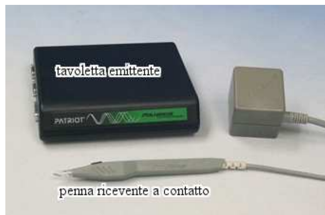
Figura 3: digitalizzatore elettro-magnetico a contatto 10
