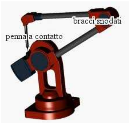
Figura 4: digitalizzatore elettro-meccanico a contatto 11
