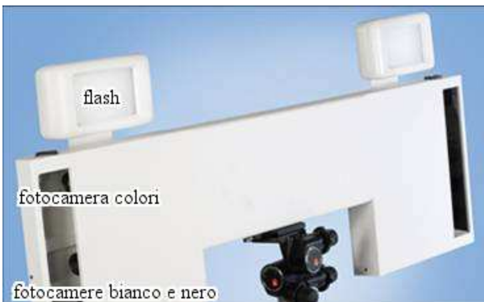
Figura 5: la strumentazione utilizzata per le acquisizioni stereo fotogrammetriche: Vectra 3D (Canfield Scientific, Fairfield, NJ). Da: Vectra User Guide 2008, Canfield Scientific.
