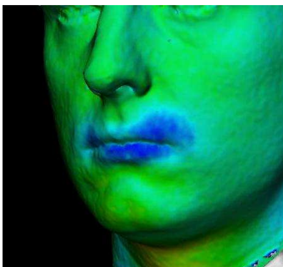
Figura 17: risultato visuale della distanza tra una superficie con spessore e la superficie baseline di riferimento sottostante. In verde le aree in cui la distanza è 0, in gradazioni di blu le aree fino a 1,5mm
