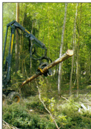
5 – Testata abbattitrice, da sinistra verso destra: fase di posizionamento; particolare della sega a catena basale; fase di sramatura; fase di sezionamento del tronco.
