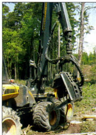
5 – Testata abbattitrice, da sinistra verso destra: fase di posizionamento; particolare della sega a catena basale; fase di sramatura; fase di sezionamento del tronco.
