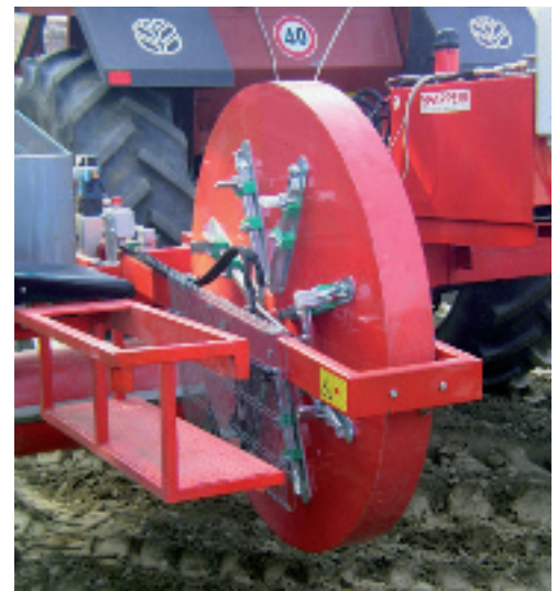
Dettaglio del disco con le pinze per l'inserimento delle talee della trapiantatrice a dischi Spapperi.
