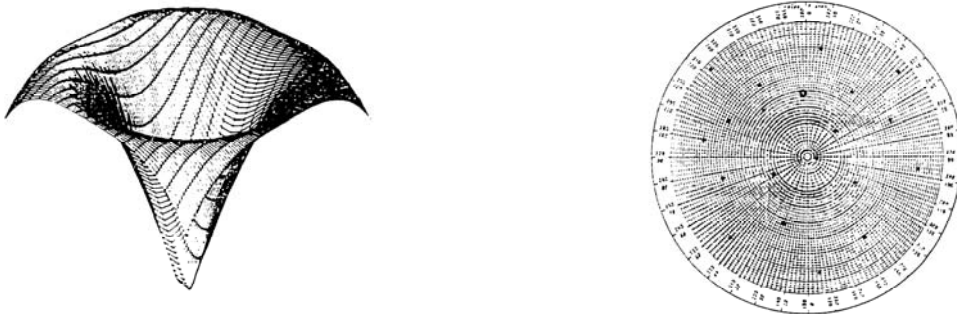
Figura 5.3: Distribuzione uniforme: a) rappresentazione tridimensionale della densità di probabilità; b) poli delle fratture in proiezione stereografica (Dershowitz W.S., Lee G., Geier J., Foxford T., LaPointe P., Thomas A.; 1998)
