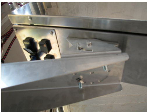
Fig. 13: Particolare della staffa e della custodia protettiva utilizzate durante le prove di trasporto su camion (Dipartimento di Scienze Animali - Università degli Studi di Milano, 2010)
