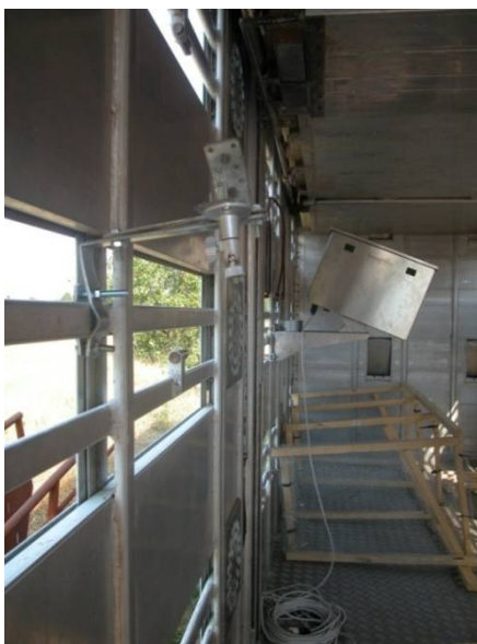
Fig.38 : Interno del veicolo utilizzato nella sperimentazione: è visibile la custodia protettiva che ospitava la termocamera (Dipartimento di Scienze Animali – Università degli Studi di Milano, 2009)
