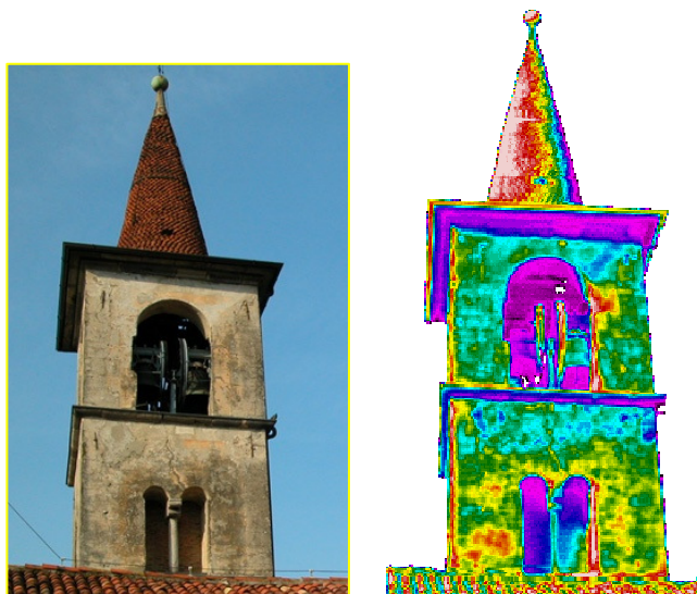
Fig. 16: Esempio di termografia su un edificio storico per la valutazione dello stato di conservazione (Inprotec Spa – Cinisello Balsamo)
