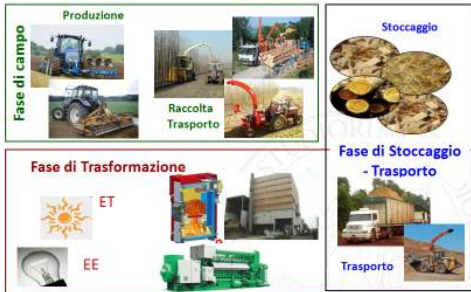
Figura 3.1 – Schematizzazione della filiera legno-energia per la produzione di energia elettrica e termica
