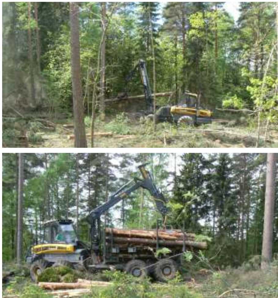
Figura 6.16 – Harvester e forwarder all'opera in fustaie di conifere in Svezia
