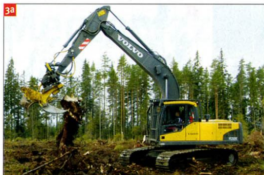
3a e 3b - Raccolta delle ceppaie mediante apposita pinza estirpatrice.
