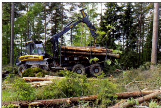
[ 6 – Forwarder in fase di raccolta del materiale allestito dall'harvester.
