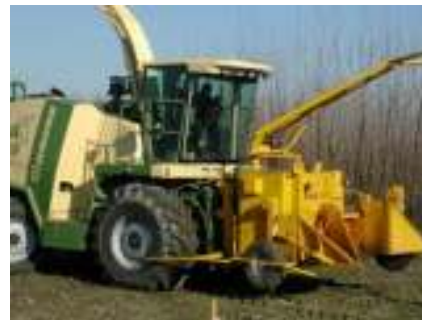
Figura 6.12 – A sinistra: Impianto di SRF biennale 2 mesi dopo il trapianto; A destra: Falciatriniciacaricatrice al lavoro
