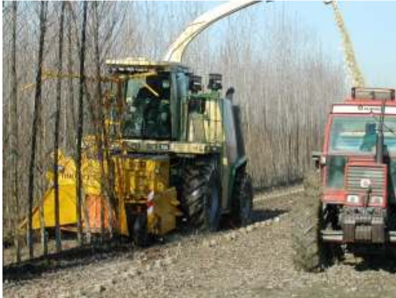
Figura 3.2 – Fase di campo, operazioni di raccolta con falciatrinciacaricatrice equipaggiata con piattaforma di taglio appositamente sviluppata per colture arboree da biomassa
