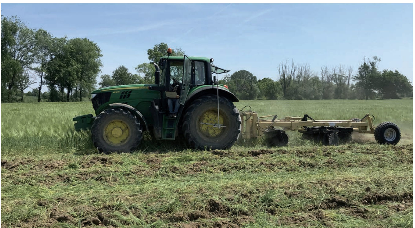
Il multiattrezzo sviluppato presso il Dipartimento di Scienze Agrarie e Ambientali dell'Università degli Studi di Milano, in configurazione rullo crimper + erpice a dischi The multi-tool developed at the Department of Agricultural and Environmental Sciences, University of Milan, in crimper roller + disc harrow configuration
