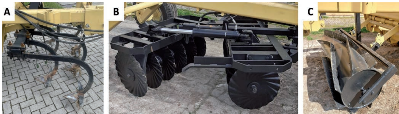
A: coltivatore ad ancore; B: erpice a dischi con angolo di apertura di 15°; C: rullo crimper A: anchor cultivator; B: disc harrow with 15° opening angle; C: crimper roller
