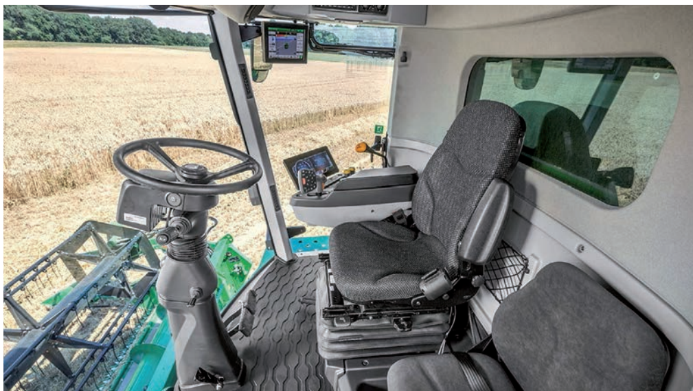
Sistema di guida semi-automatica con attuatore collegato al piantone dello sterzo (cortesia: www.deere.com ) Semi-automatic steering system with actuator connected to the steering column (courtesy: www.deere.com )
