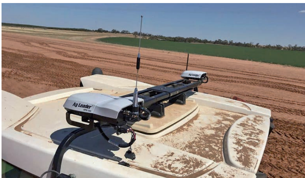
Sistema di guida semi-automatica con doppia antenna (cortesia: www.arvatec.it ) Semi-automatic guidance system with dual antenna (courtesy: www.arvatec.it )
