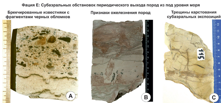
Рис. 4. Фото образцов фашии Е. Пример образцов со следами субаэральных обстановок на примере образцов Ново-Елховского (А) и Ивинского месторождений (В, С). А – карбонатная брекчия, В – мадстоун-баундстоун со следами интенсивного ожелезнения, С – мадстоун с трещинами карстования, выполненными глинистым материалом, и признаками ожелезнения.
