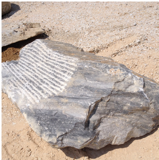
Fig. 5. Fossacava/La Fabbrica. Masso di marmo bardiglio con tracce di taglio a piccone.
