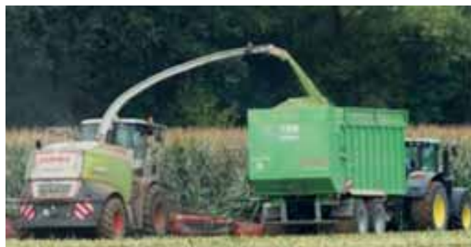
Llenado completo de la caja del remolque mediante análisis de imagen.
