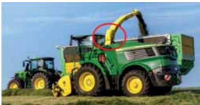
Análisis de la composición del forraje mediante analizador NIR.
