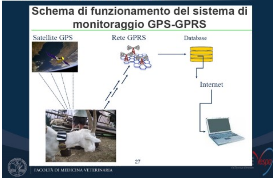
Figura 6 - Schema esemplificativo del sistema per il monitoraggio del gregge
