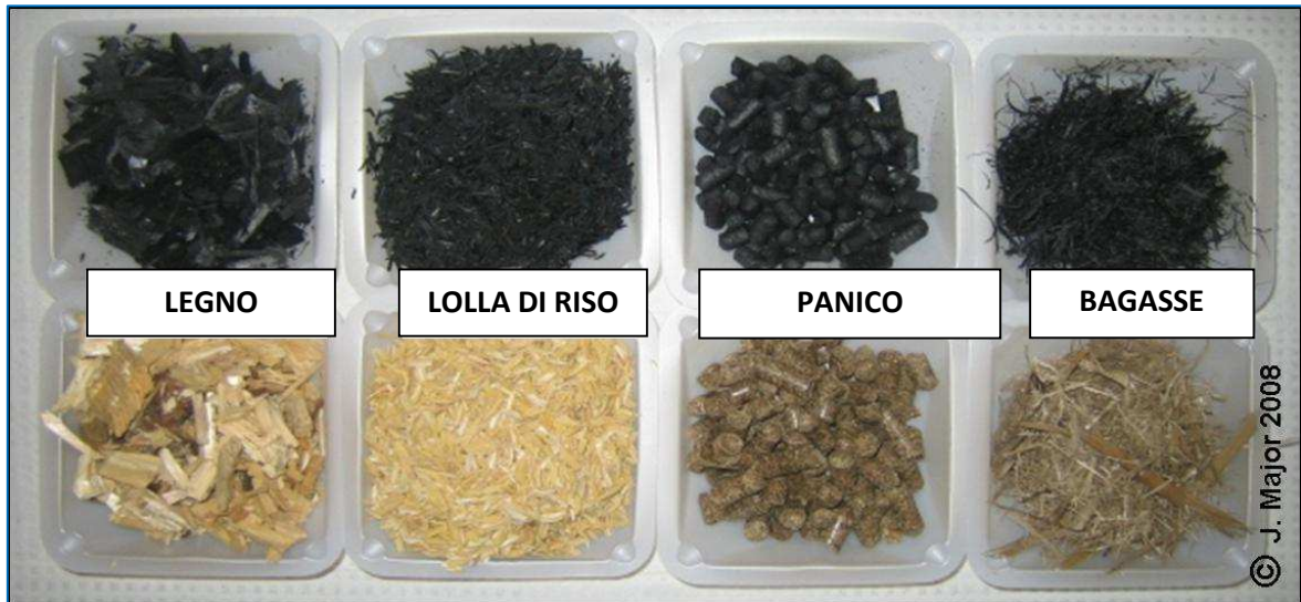
Fig. 2 - Confronto tra la biomassa di partenza ed il biochar ottenuto
