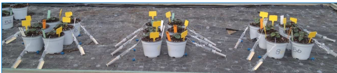
Fig. 2 - Vasi muniti di campionatore Rhizon per prelevare la soluzione circolante
