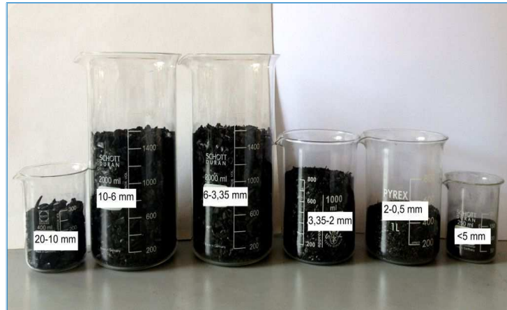
Fig. 4 - Suddivisione granulometrica di 500g di S-Bc1
