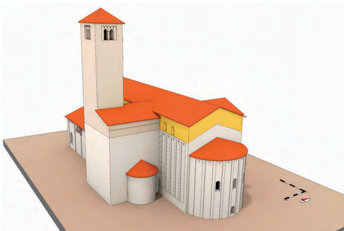
31-32. Modello ricostruttivo che evidenzia le diverse fasi costruttive: in tonalità neutra la Fase I; in rosa la Fase II; in arancio la Fase III.
