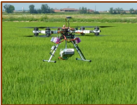
Fig.5.4- Secondo drone utilizzato in campo. Si vede il sensore direttamente montato a bordo
