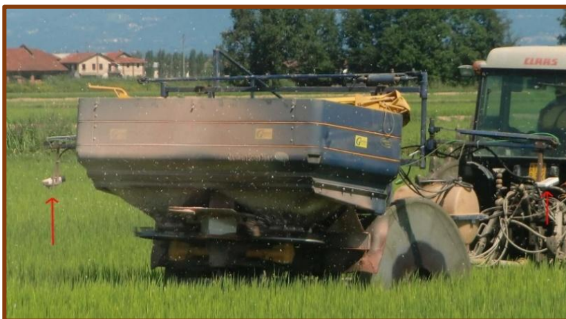
Fig. 4.1- Spandiconcime Bogballe mentre sparge il fertilizzante alla fase di differenziazione della pannocchia. I sensori OptiRx che rilevano in continuo i valori di NDRE sono evidenziati dalle frecce rosse
