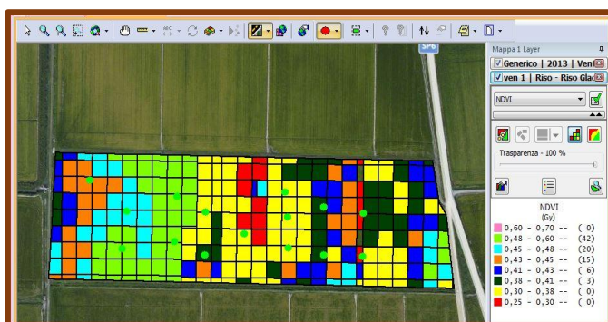
Fig. 5.3– Tavola georeferenziata degli indici di vigore rilevati da esacottero, e scelta dei punti di prelievo (cerchi verdi)
