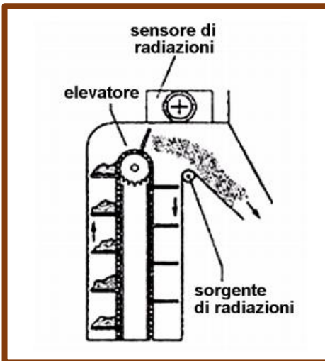
Fig.2.3 - Schema di funzionamento di un sensore di resa con detector a raggi gamma
