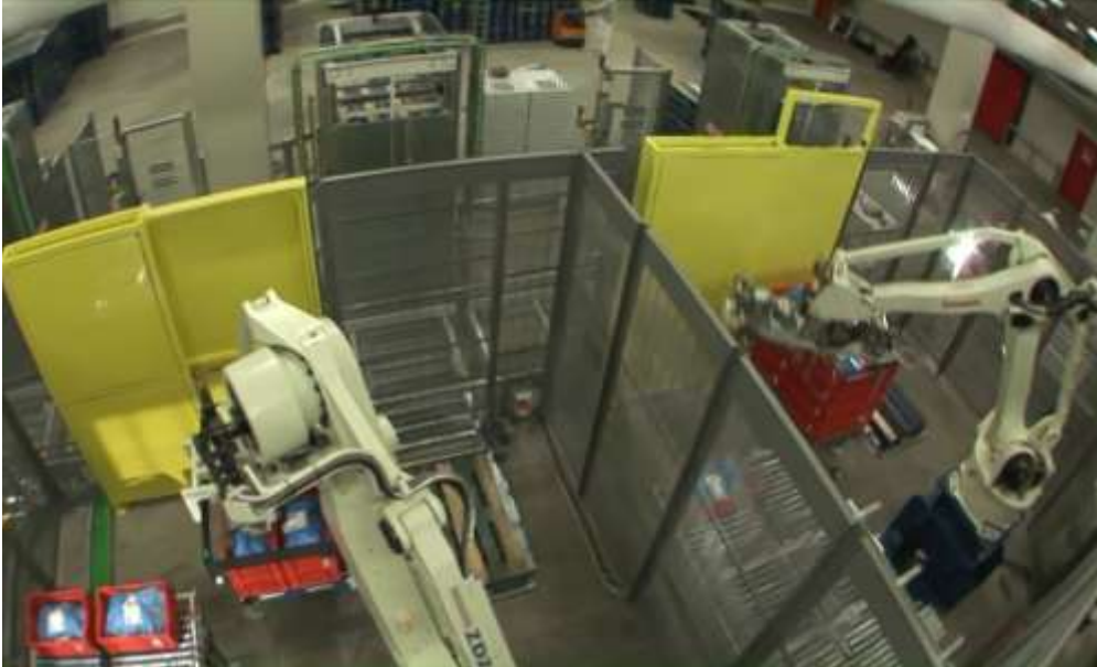
Figura 12. Movimentazione eurocontenitori con ausilio di robot.
