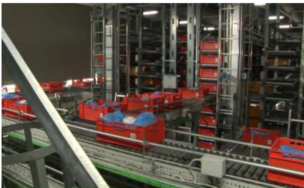
Figura 11. Stoccaggio casse nel grande magazzino automatico
