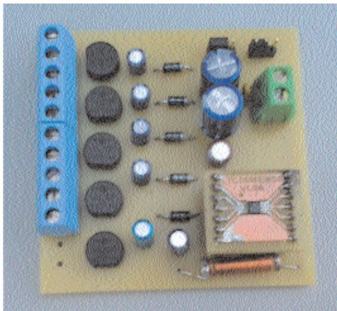
Figura 1 – Circuito di accumulo del sistema di conversione
