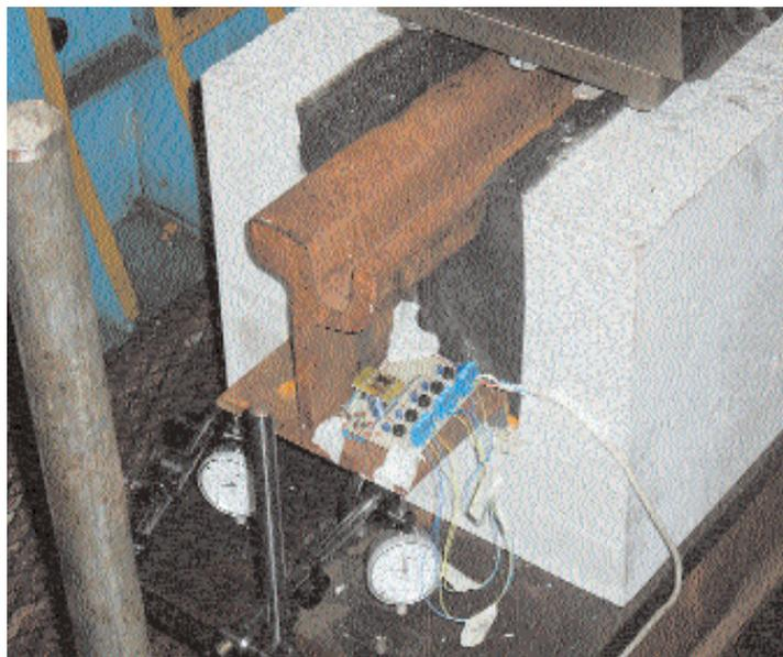
Figura 2 – Simulacro di *embedded rail system* equipaggiato con un modulo di generazione piezoelettrica e circuito di accumulo
