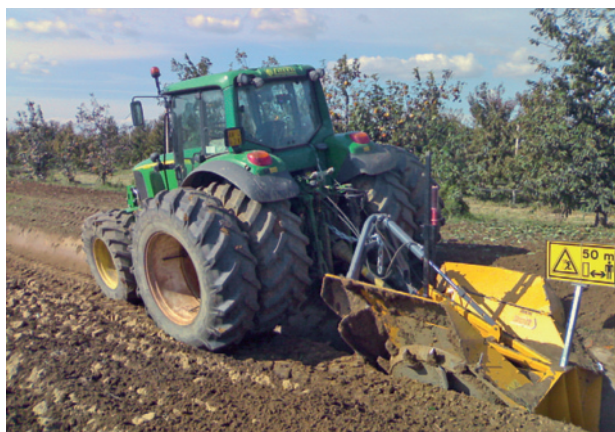
Per la miglior operatività con lo scavafossi, è opportuno che il trattore sia equipaggiato con pneumatici gemellati posteriori. Inoltre, per allargare la carreggiata anteriore è possibile invertire gli pneumatici.
