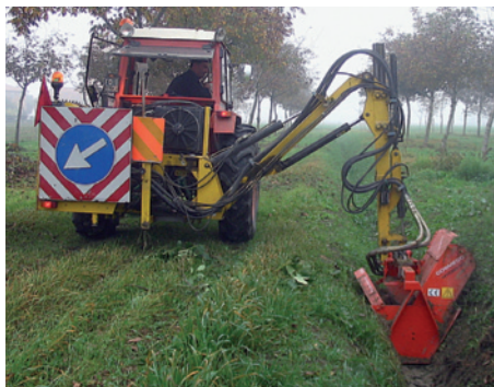
L'affossatore Hydro50 della Cosmeco; il montaggio su bracci idraulici permette la pulizia di fossi anche a notevole distanza dal trattore.
