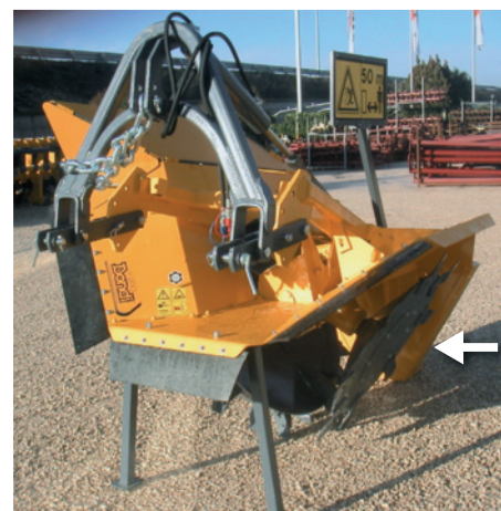
Uno scavafossi mono-biruota. La freccia indica la ruota di piccole dimensioni destinata al risezionamento della sponda.
