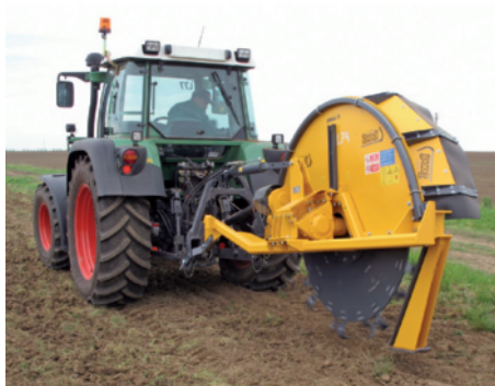
Il DondiDrenag realizza un "taglio" verticale del terreno idoneo alla posa di dreni, tubazioni o cavi.
