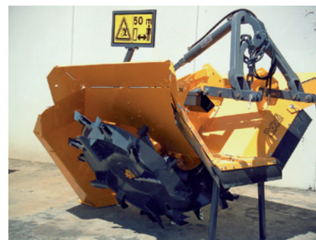
Uno scavafossi biruota di grandi dimensioni. Si noti la forma e la disposizione degli utensili di scavo saldati sulla circonferenza della ruota (fonte: Dondi).
