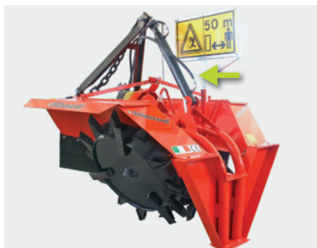
Un affossatore biruota della Gherardi. La freccia indica il cilindro idraulico che permette di alzare la "coda" dell'affossatore, per poter uscire dallo scavo.
