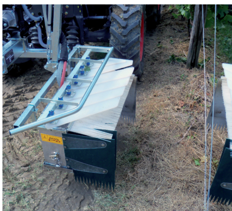
L'apertura degli schermi rende più semplice la centratura della macchina all'ingresso nel filare.
