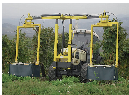
Le spollonatrici chimiche di Tecnovict, a una (sopra) e a due file (sotto) possono essere completate con il dispositivo per la regolazione automatica della dose distribuita in relazione alla velocità di avanzamento.
