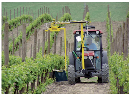
La spollonatrice bifilare di AgricolMeccanica-Friuli Sprayers sul supporto autoportante. La parte di destra evidenzia gli schermi aperti.
