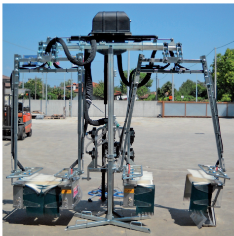
La spollonatrice bifilare di AgricolMeccanica-Friuli Sprayers sul supporto autoportante. La parte di destra evidenzia gli schermi aperti.
