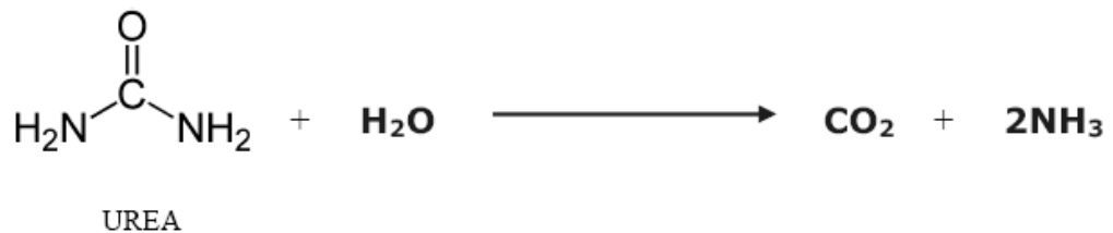
Figura 1.2 - Reazione di idrolisi dell'urea, catalizzata dall'enzima ureasi
