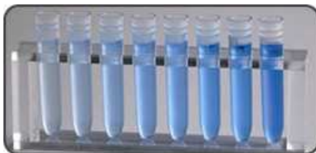
Figura 4.1 – Colorazione assunta dai campioni dopo la reazione con reattivo di Folin-Ciocalteu e soluzione di carbonato di sodio
