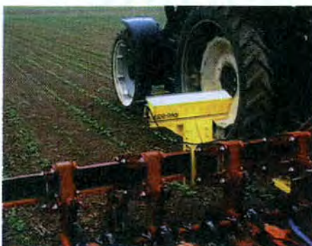
Foto 2 - Particolare del sistema di visione che individua le piante e governa la posizione della macchina portata
