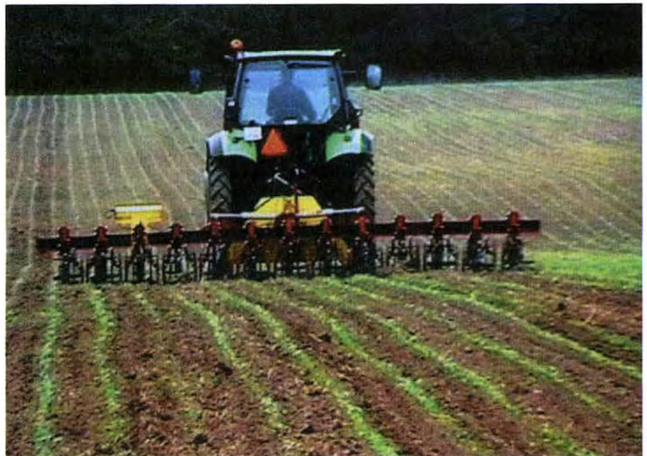
Foto 1 - Il sistema di controllo ATC (al centro, in giallo) è interposto tra il trattore e la macchina operatrice. Sul 3° elemento da sinistra si nota il sistema di visione
