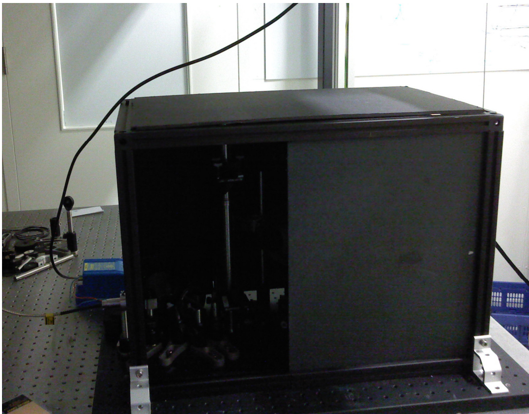
Fig. 9.2 – box di sicurezza ottica contenente l'intero setup di misura con esclusione del laser (fascio in arrivo dalla fibra ottica visibile a sinistra).
