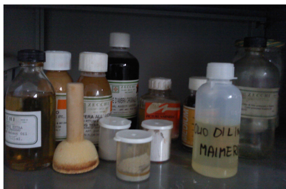
Fig. 2.3 – alcuni dei principali leganti per pigmenti: a sinistra l'olio di lino pressato a freddo, con a fianco la tempera all'uovo.
