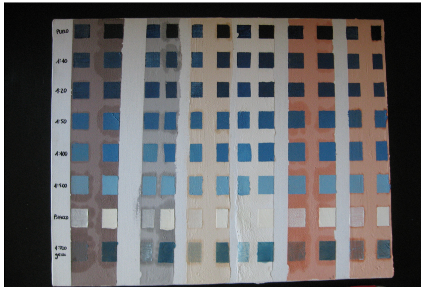
Fig.12.2 – Prove di colore di blu di Prussia sulle preparazioni colorate. Dall'alto al bianco i campioni contengono nella mescolanza sempre più pigmento bianco (biacca). La prima riga è realizzata con blu di Prussia puro, mentre la settima con sola biacca. L'ultima riga è una mescolanza 1: 550 di blu di Prussia e gesso. Per ciascuna preparazione la colonna di sinistra è realizzata in velature sottili, mentre quella di destra in stesura spessa coprente.
