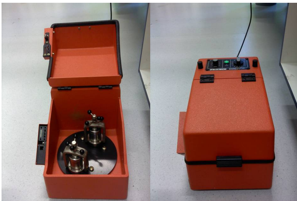
Fig. 10.1 – Ball mill per la macinazione di polveri. È costituito da due cilindri sigillati in acciaio contenuti oltre alla polvere da macinare anche sette sfere di acciaio ciascuno. La macinazione della polvere avviene per centrifuga con moto epicicloidale: infatti i cilindri ruotano contemporaneamente sul proprio asse e su una circonferenza e su una piattaforma con asse di rotazione non coassiale a quello del cilindro. A destra la ball mill aperta, a sinistra chiusa durante il processo di macinazione.
