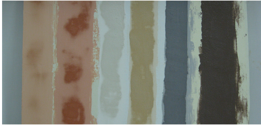
Fig. 12.1 – Preparazioni colorate usate per le simulazioni di laboratorio: da sinistra a destra cora rossa di provenza (F), ocra rossa con cinabro (E), bianco di piombo (D), terra di Siena chiara (C), nero di vite (B), terra di Siena bruciata (A).
