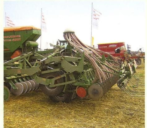
Esempio di macchine combinate per la minima lavorazione o semina su sodo
