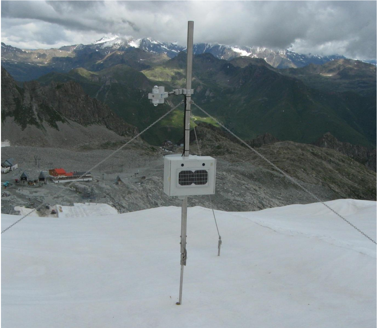
Fig. 31: Radiometro netto installato sulla superficie della copertura geotessile posizionata sul Ghiacciaio Presena. (Foto M. Donati)
