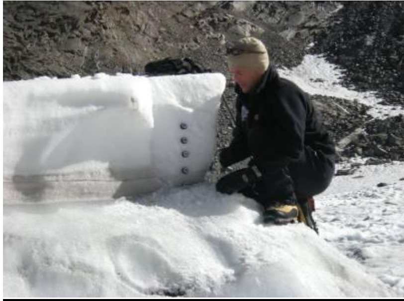
Fig. 14: Misura della temperatura della neve al di sotto della copertura durante l'esecuzione del profilo nivologico di fine stagione (3-10-2009).
