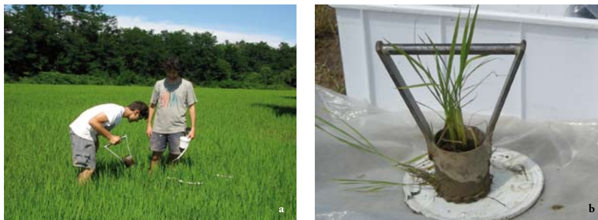
Fig. 12 - Operazione di raccolta dei campioni (a); particolare del carotatore (b).
