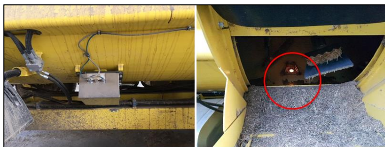
Figura 8. A sinistra: analizzatore NIR montato all'esterno del cassone di miscelazione. A destra: interfaccia ottica dell'analizzatore. La posizione sul fondo del cassone in prossimità del nastro trasportatore di scarico fa sì che un flusso continuo di materiale investa l'interfaccia ottica durante la fase sia di miscelazione, sia di scarico permettendo di monitorare l'omogeneità della razione in continuo (Immagine dell'autore).
