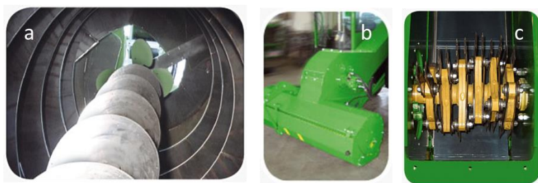
Figura 4. A sinistra: vista interna della botte rotante con parete interna spiralata (A), coclea centrale controrotante (B) rispetto alla botte stessa e pale di contrasto (C). Al centro: fresa di carico e mulino a coltelli. A destra: particolare del mulino a coltelli (Fonte: https://bravosrl.it ).
