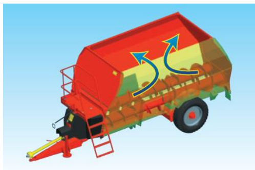
Figura 2. Esempio di carro trinciamiscelatore trainato a 2 coclee. Le coclee con spire convergenti determinano la risalita del prodotto nella parte centrale del cassone originando flussi che vanno a ricadere verso il basso nella parte anteriore e posteriore del cassone per poi riprendere il ciclo di miscelazione (Fonte: https://sekoindustries.com )
