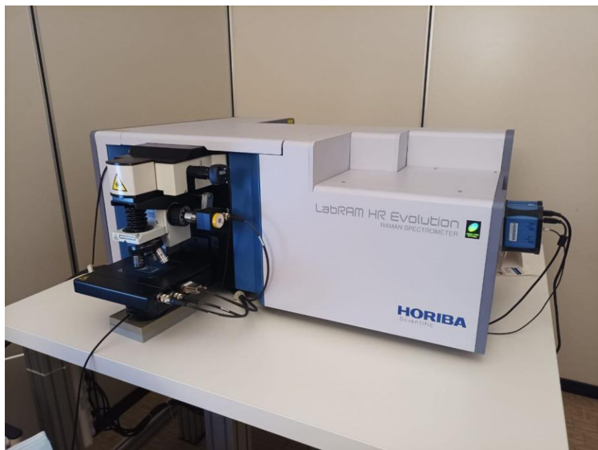
Figure 7. The Raman spectrometer used for this study, thanks to prof. Patrizia Fumagalli (Dipartimento di Scienze della Terra, Università degli Studi di Milano)
