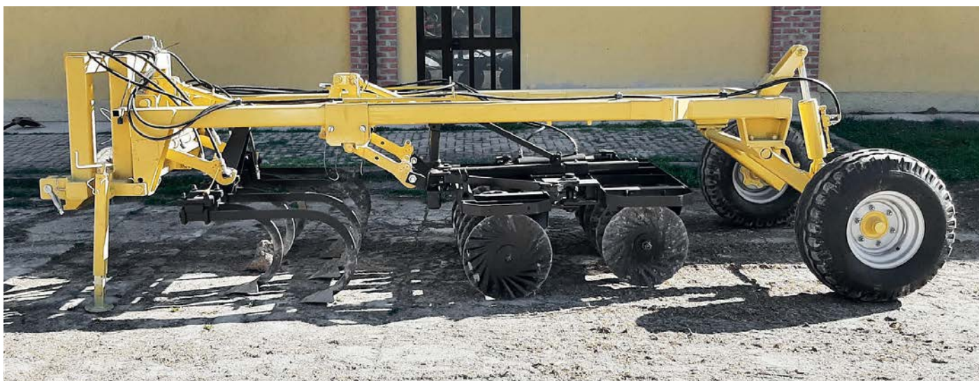
Foto 1 Il prototipo, progettato dal gruppo di meccanica agraria del Dipartimento di scienze agrarie e ambientali (Disaa) di Milano, nella configurazione coltivatore ad ancore + erpice a dischi
