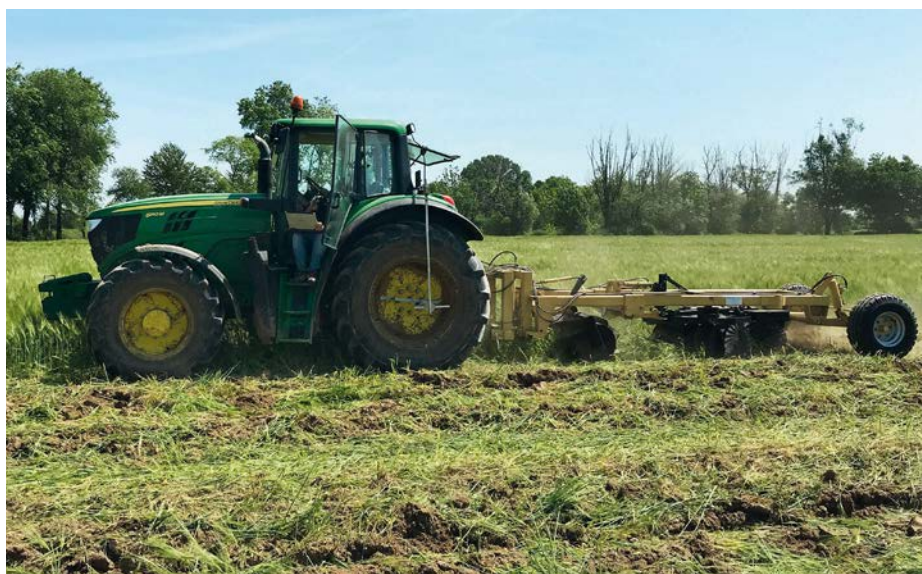
Foto 2 Il prototipo al lavoro nella configurazione rullo crimper + erpice a dischi
