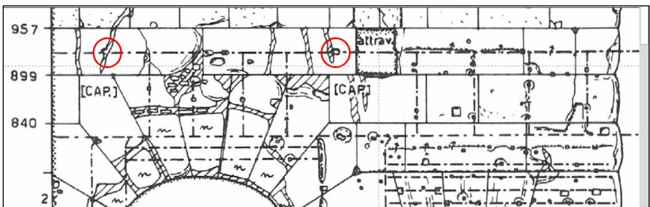
Fig. II.27 Rilievo di Bauer del muro di fondo del portico. In evidenza i fori per le grappe collegabili con i capitelli
