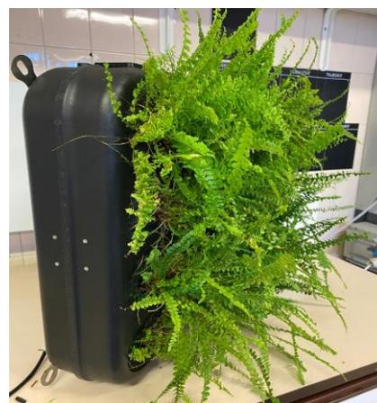
Fig 1. Singolo modulo del biofiltro botanico (dimensioni: 51.5x50x11 cm)
