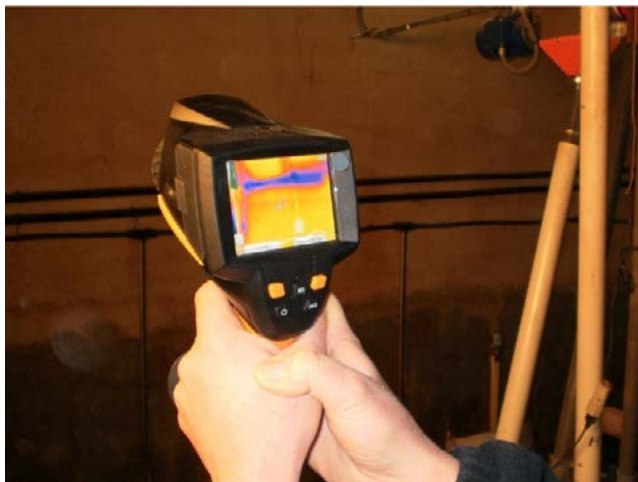
Figura 2: utilizzo della termocamera per valutare lo stato di isolamento termico dell'edificio (foto di Dott. Escobet Riu)
