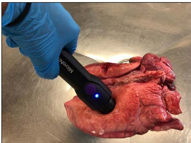
Figura 1. Acquisizione degli spettri NIR del tessuto polmonare suino tramite spettrometro NIR portatile.
