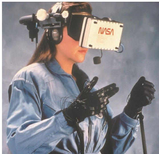
Fig. 6: The Virtual Interface Environment Workstation (VIEW), dispositivo di realtà virtuale utilizzato dalla NASA e sviluppato in collaborazione con VPL Research, Inc. (1990). Sito ufficiale NASA: https://www.nasa.gov/ames/spinoff/new_continent_of_ideas/ .
