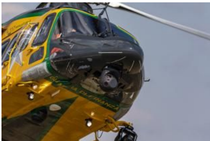
Fig. 36: Torretta di controllo LEOSS-S montata su un elicottero della Guardia di Finanza. Sito ufficiale Leonardo: https://electronics.leonardo.com/it/products/leoss .
