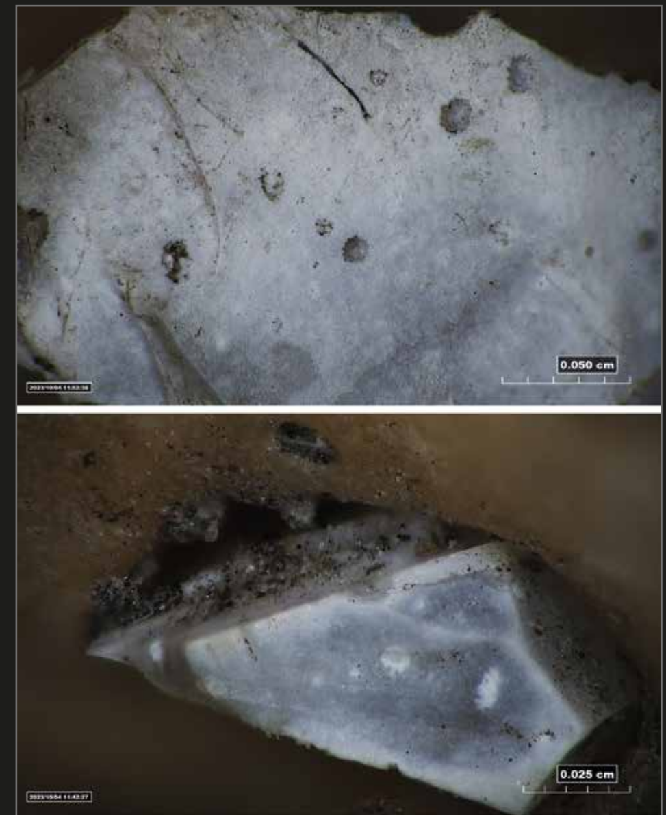
Fig. 3. Visione in microscopia della materia prima dell'elemento litico
