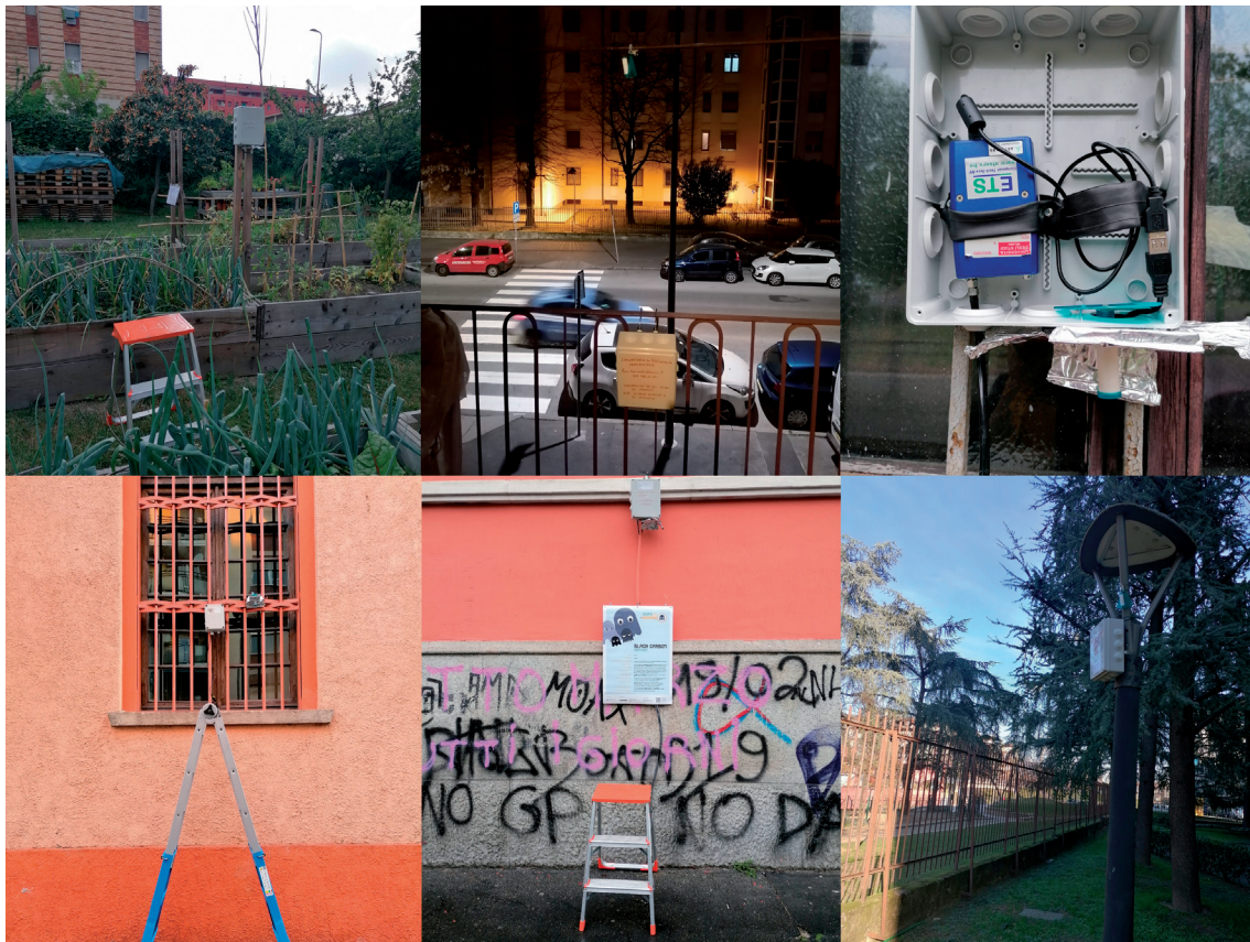
Figure 3. Examples of monitoring sites made available and partly maintained by the civil society. Above on the right, the monitoring unit in detail, consisting of a black carbon sampler with two outputs, one for the sampling tube and one for the energy supply (in this case supplied by the electricity network) and the passive VOC Radiello® sampler (below on the right). Figura 3. Esempi di siti di monitoraggio messi a disposizione e in parte curati dalla società civile. In alto a destra la centralina nel dettaglio, composta da un campionatore di black carbon con due uscite, una per il tubo di campionamento e una per l'alimentazione energetica (in questo caso a rete elettrica) e il campionatore passivo Radiello® per i BTEX (in basso a destra).
