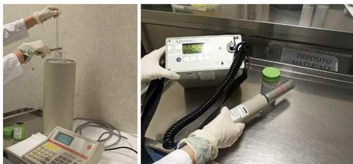
Figura 10: Misura dell'attività del radiofarmaco e misura rateo esposizione del vial di LUTATHERA® nel suo contenitore schermato
